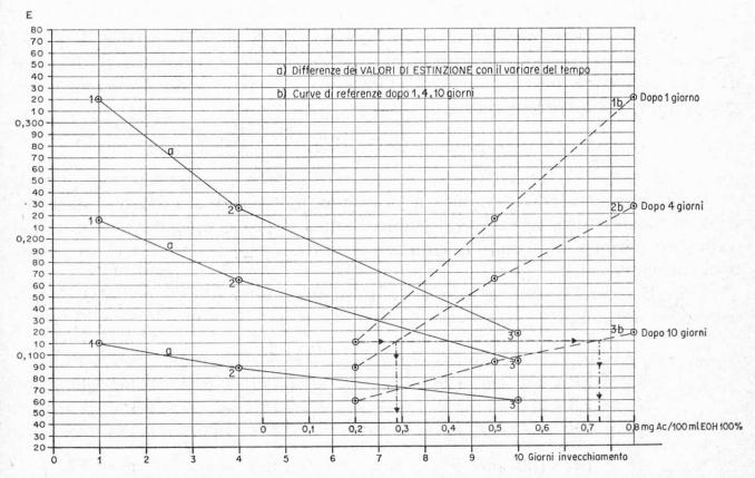
Fig. 3. Cambiamento dei valori d'estinzione di soluzioni di acroleina con il variare del tempo (0.8 / 0.5 / 0.2 mg / 100 ml).
