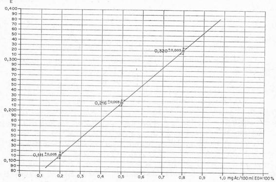
Fig. 4. Linea di riferimento ottenuta con acroleina distillata.
