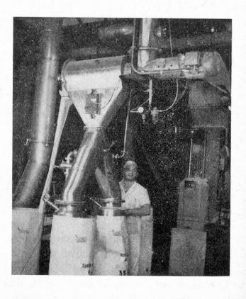
Abbildung 11 Meßstelle mit Meßwertgeber-Einheit beim Absacken an einem Sprühtrockner.
