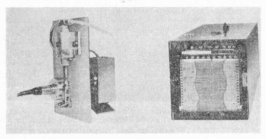
Abbildung 7 SINA-SCOPE Feuchte-Ueberwachungsanlage A 100. Links: Meßwertgeber-Einheit, an der Meßstelle anzubringen. Rechts: Auswertegerät, SINA-SCOPE 2-Kanalschreiber, in beliebiger Entfernung von der Meßstelle aufstellbar.
