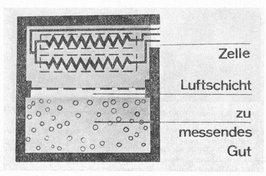
Abbildung 4 Schematische Darstellung der equi-HYGRO-SCOPE Feuchtemessung an Einzelproben.
