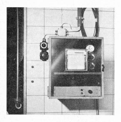
Abbildung 9 Auswertegerät mit Steuereinheit in staubdicht geschlossenem Kasten.
