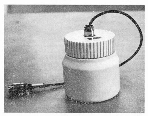
Abbildung 5 equi-HYGRO-SCOPE Meßbehälter mit Feuchtegeber für größere Körper.
