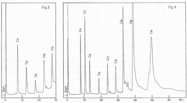
Butterfett: GC der freien Fettsäuren.  $10\,\%$  Carbowax, 20M TPA auf Aeropak-30, 100/120 mesh  $1 \text{ m} \times {}^{1}/{}^{8}$ ". Temperaturprogrammiert  $100\,\circ\text{C} + 4\,\circ/\text{min}$ . bis  $250\,\circ\text{C}$ . Figur 3. Butterfett ohne inneren Standard. Figur 4. Butterfett mit Valeriansäure (C<sub>5</sub>) als innerem Standard.
