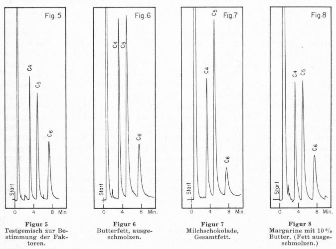
Bedingungen. Säule: 10 % Carbowax, 20M TPA auf Aeropak-30, 100/120 mesh. 0,25  $\mu$ l eingespitzt. 160 ° C isotherm.
