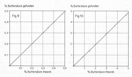
Modellversuche mit Mischungen von Tributyrin und Olivenöl für die Konzentrationsbereiche 0,1 bis 0,5 % und 0,9 bis 5 % Buttersäure.
