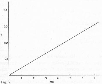
troduce nella cella di misura e si traccia lo spettro IR tra 1800 e 1500 cm<sup>-1</sup>, usando come riferimento una identica cella contenente etere di petrolio. Si misura l'assorbimento a 1650 cm<sup>-1</sup> e si traccia la curva di taratura riferita al ciclamato sodico, riportata in fig. 2. La legge di Lambert-Beer è rispettata fino a 7 mg.
