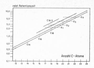
Figur 6. Rapsöl. Beziehung zwischen relativer Retentionszeit der Fettsäuren-Methylester und der Anzahl C-Atome.
