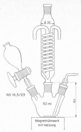
Figur 13. Hydrierapparatur.
