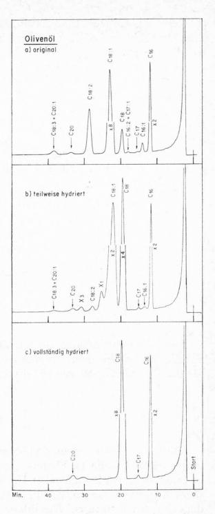
Figur 4. GC der Fettsäuren-Methylester von Olivenöl vor, nach teilweiser und nach vollständiger Hydrierung.
