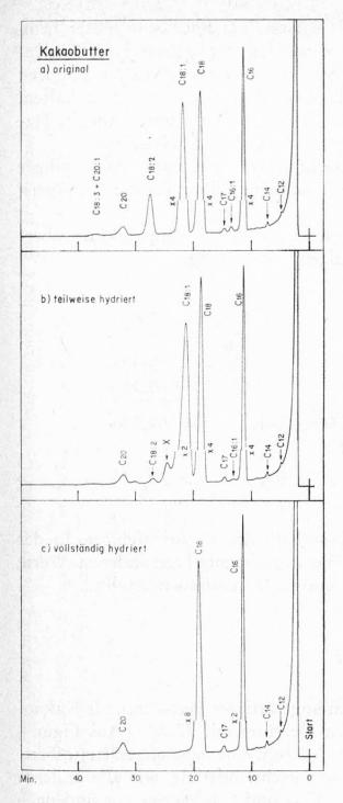
Figur 3. GC der Fettsäuren-Methylester von Kakaobutter vor, nach teilweiser und nach vollständiger Hydrierung.
