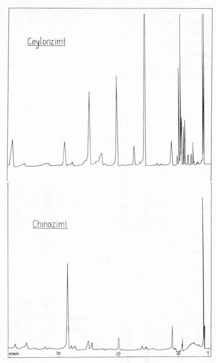
Abbildung 4 Ceylon- und Chinazimt-Extrakte mit Kapillarsäule, isotherm 130 ° C
