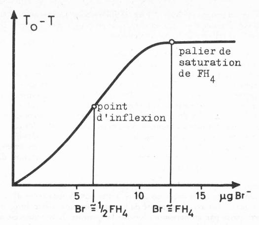
Figure 2. Courbe d'étalonnage d'après notre méthode.
