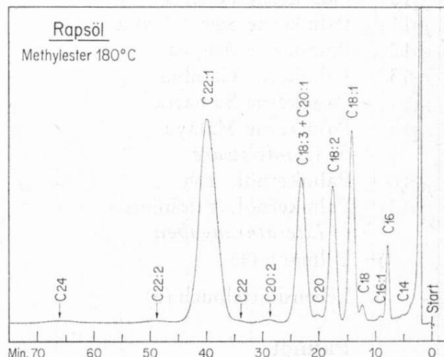
Die gaschromatographische Trennung erfolgte auf einer Säule mit 10 % Polyäthylenglycolsuccinat auf Chromosorb W, säuregewaschen und mit Dimethylchlorsilan behandelt. Die apparativen Bedingungen sind in der früheren Arbeit (1) genau beschrieben worden. Die Säulentemperatur variierte je nach Zusammensetzung der Öle. (Siehe Angaben auf Übersichtschromatogrammen).
