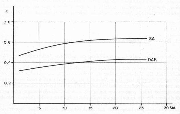
Abbildung 4. Kinetik der Ausbildung der Reaktionsprodukte
