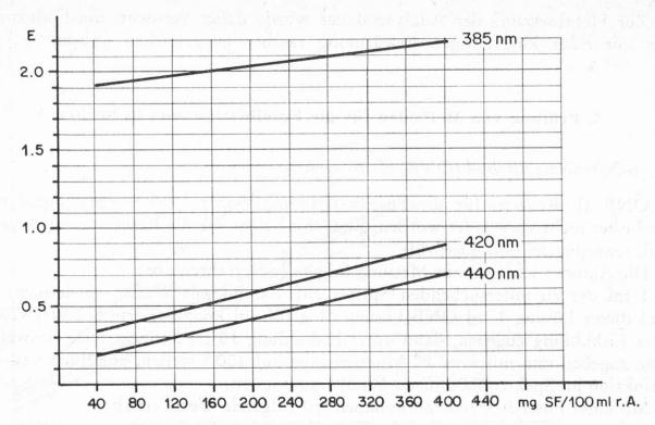
Abbildung 5. Extinktionswerte mit ONB nach Maurel et al.
