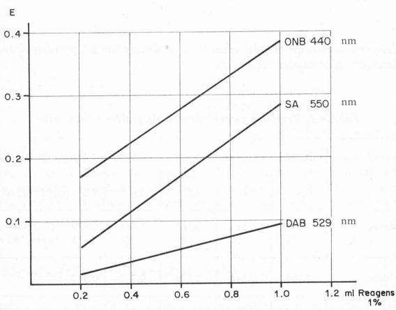
Abbildung 2. Extinktion in Abhängigkeit der Reagenskonzentration
