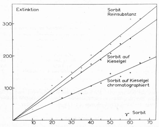
Abbildung 3. Beeinflussung der Farbintensität von Eichkurven durch das Trägermaterial und den Chromatographievorgang.
