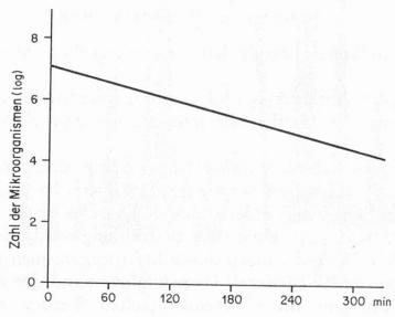
Abbildung 1: Abtötungskurve bei konstanter Temperatur für Saccharomyces cerevisiae in Malzlösung pH 3 bei 50 °C. D = 114 Min. (Lubienieckavon Schelhorn, 3).
