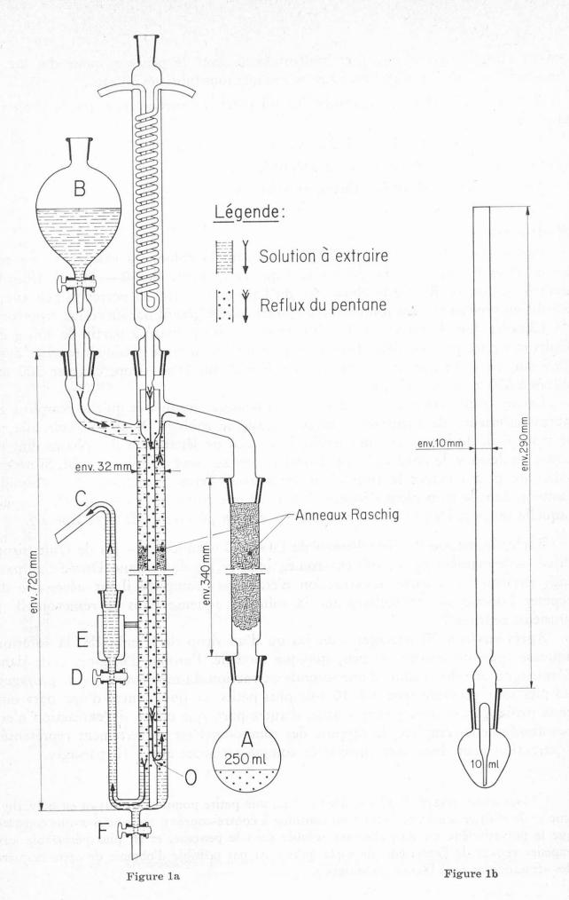
prévus afin d'assurer l'équilibre hydrostatique avec le pentane, pour des jus et des sirops de densité différente. Tous les rodages sont lubrifiés à l'eau.
