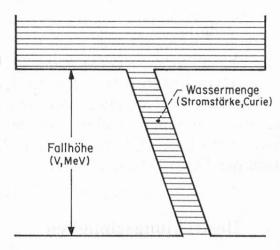
Abbildung 2: Beziehung zwischen Fallhöhe und Wassermenge zu Volt und Stromstärke bzw. MeV und Curie.
