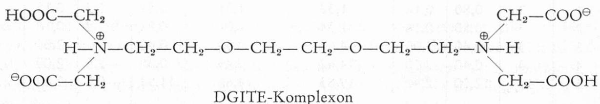
Wie aus obigen Formeln ersichtlich, sind im DGITE-Komplexon die beiden Stickstoffatome durch eine 8gliedrige Kette von 6  $\text{CH}_2$ -Gruppen und 2 ätherartig gebundene O-Atome getrennt. Im üblichen AeDTE-Komplexon befinden sich zwischen den beiden N-Atomen nur 2  $\text{CH}_2$ -Gruppen.
