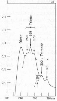
Figur 25. Gleiches Olivenöl 30 Minuten mit Bleicherde behandelt.
