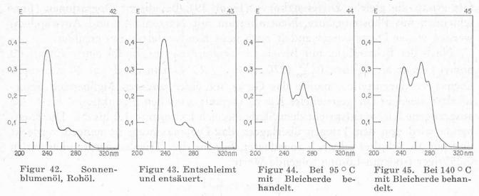
Ol ist etwas höher. Ein Teil dieses Sonnenblumenöls wurde nun bei 95°C, ein anderer Teil bei 140°C unter sonst gleichen Bedingungen mit Bleicherde behandelt. Aus den Figuren 44 und 45 geht deutlich hervor, daß bei höherer Temperatur bedeutend mehr Diene verschwunden und mehr Triene entstanden sind.
