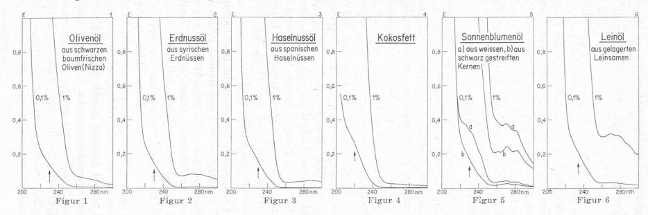
Figuren 7—12. UV-Differenzkurven von selbst isolierten Ölen. Messung von 0,5 % bzw. 0,25 % Lösungen in Isooctan gegen 1 % Stearinsäure-methylester als Modellsubstanz.
