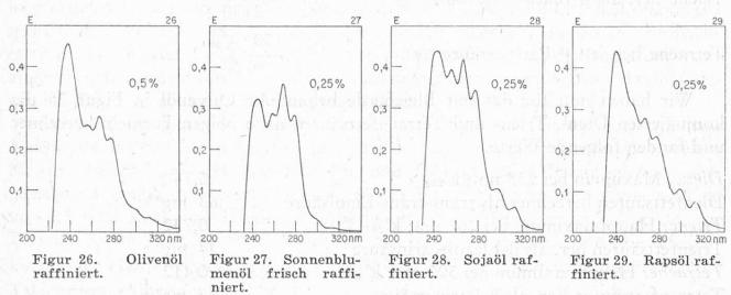
lerweise der Fall ist. Im frisch raffinierten Sonnenblumenöl (Figur 27) treten vor allem die 3 Trienbanden stark hervor. Die Dienbande ist etwas weniger hoch, aber deutlich ausgebildet. Die beiden Tetraenbanden sind nur leicht angedeutet.
