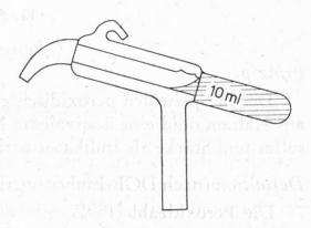
Figur 3 Automatisches Meßgefäß (Kippautomat).
