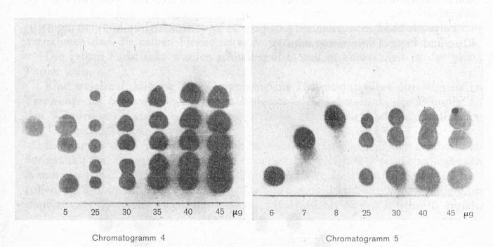
Der Farbfleckvergleich zeigt deutliche Größenveränderung welche von der aufgetragenen Säuremenge abhängig ist. Um die beobachteten Effekte zahlenmäßig und statistisch zu erfassen, wurden über 50 Chromatogramme von Säuremischungen verschiedener Konzentration (25, 30, 35, 40 und 45 µg) angefertigt. Es wurden über 2000 Bestimmungen durchgeführt, die der statistischen Ana-
