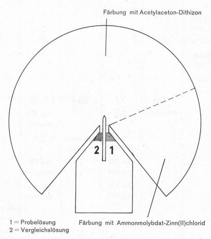
Abbildung 8 Färbung eines Doppelsektorfilters mit zwei Reagenzien
