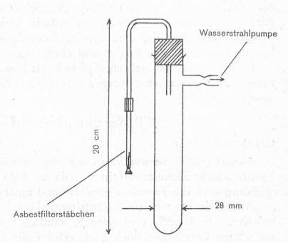
Abbildung 2 Absaugvorrichtung mit Asbestfilterstäbehen
