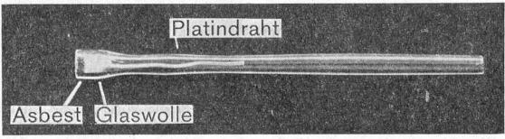
Abbildung 3 Asbestfilterstäbchen
