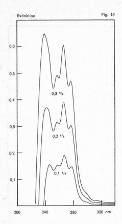
Differenz-Absorptionsspektrum von Sonnenblumenöl gemessen in Isooctan gegen 1 % Stearinsäure-methylester (1 cm Küvette).
