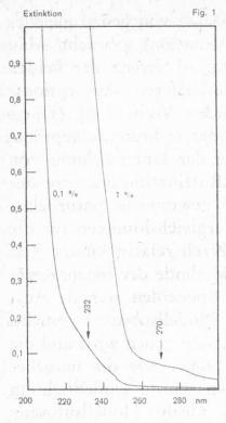
UV-Absorptionsspektrum von selbst extrahiertem Olivenöl 0,1% und 1% in Isooctan (1 cm Küvette).
