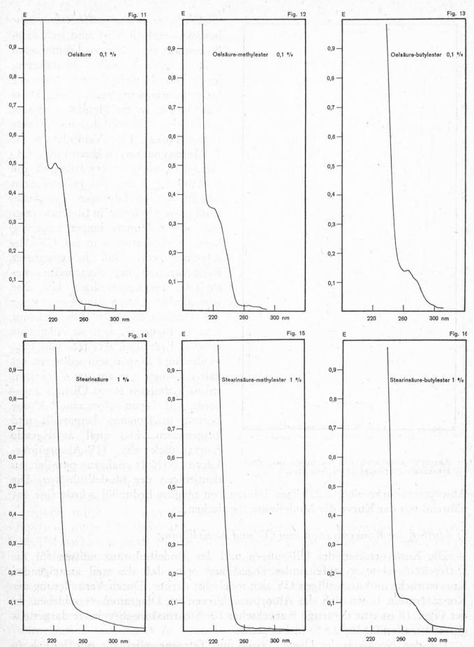
UV-Absorptionsbanden verschiedener Modellsubstanzen in 0,1% bzw. 1% in Isooctan (1 cm Küvette).
