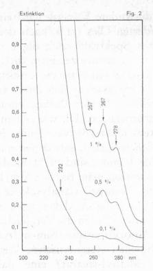
UV-Absorptionsspektrum von raffiniertem Olivenöl 0,1%, 0,5%, 1,0% in Isooctan (1 cm Küvette).
