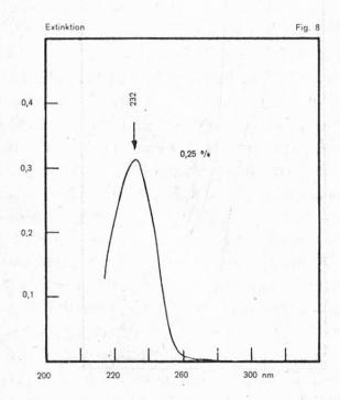
Klassische Differenz-Absorptions-Analyse von Rapsöl vor und nach Autoxydation.  $0,25\,$ % in Isooctan (1 cm Küvette).
