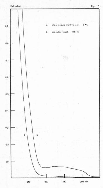
Absorptionsspektren von Erdnußöl und Stearinsäure-methylester (1 cm Küvette).
