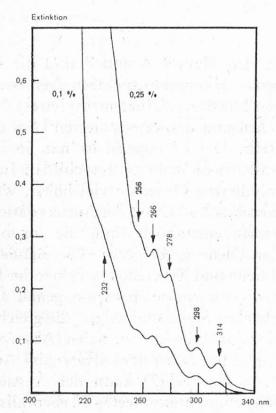
Figur 4 UV-Absorptionsspektrum von raffiniertem Rapsöl 0,1 % und 0,25 % in Isooctan (1 cm Küvette).
