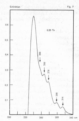
Differenzabsorptionskurve von raffiniertem Rapsöl nach Autoxydation. 0,25 % in Isooctan, gemessen gegen 1 % Stearinsäure-methylester in 1 cm Küvette.
