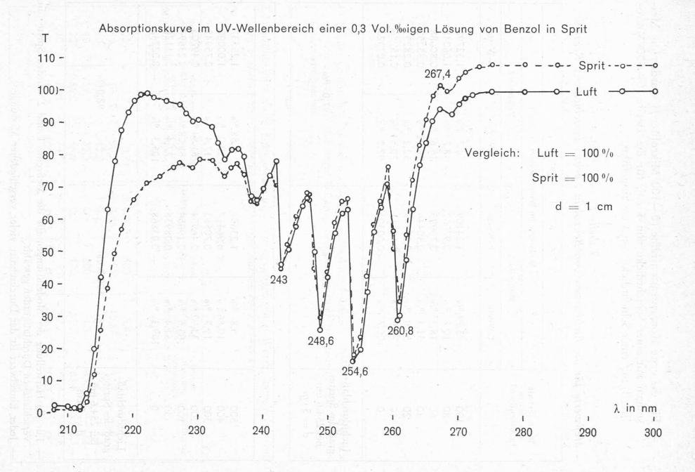
— Für die erste Konzentrationsreihe (0—100 Mikroliter/l) wurden die Messungen mit einer Schichtdicke von 5 cm, für die zweite (0—500 Mikroliter/l) mit einer Schichtdicke von 1 cm ausgeführt.
