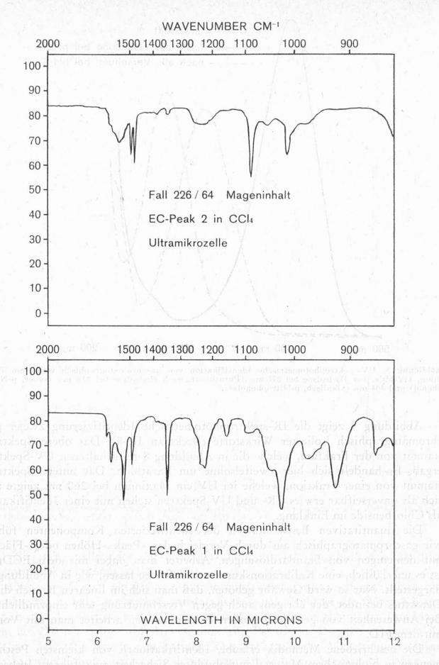
Abbildung 9. IR-spektrophotometrische Identifikation von gaschromatographisch isoliertem Parathion (unten) und Chlorbenside (oben) aus einem Vergiftungsfall mit Aralo (Maag).
