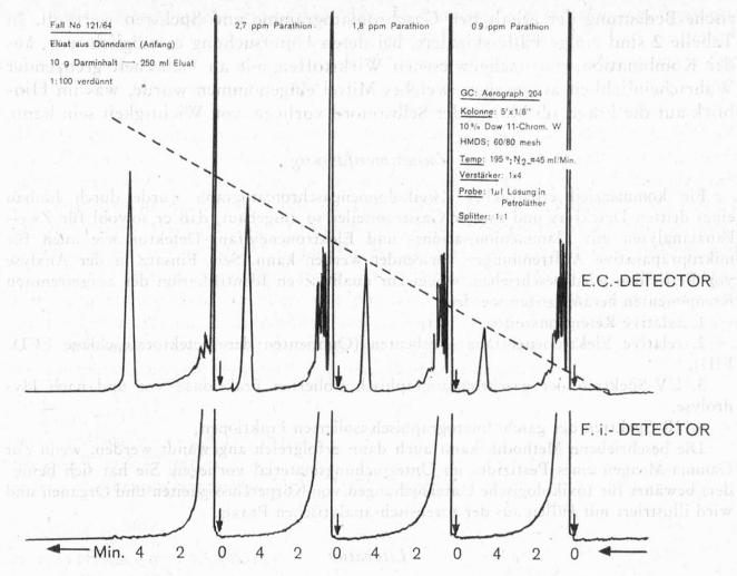
Abbildung 10. Quantitative gaschromatographische Bestimmung des Parathiongehaltes mit Hilfe des ECD.
