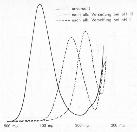
Abbildung 8. UV-spektrophotometrische Identifikation von gaschromatographisch isoliertem Parathion. UV-Max. vor Hydrolyse bei 275 m $\mu$  (Parathion), nach Hydrolyse bei 318 m $\mu$  (sauer, p-Nitrophenol) und 404 m $\mu$  (alkalisch, p-Nitrophenolat).
