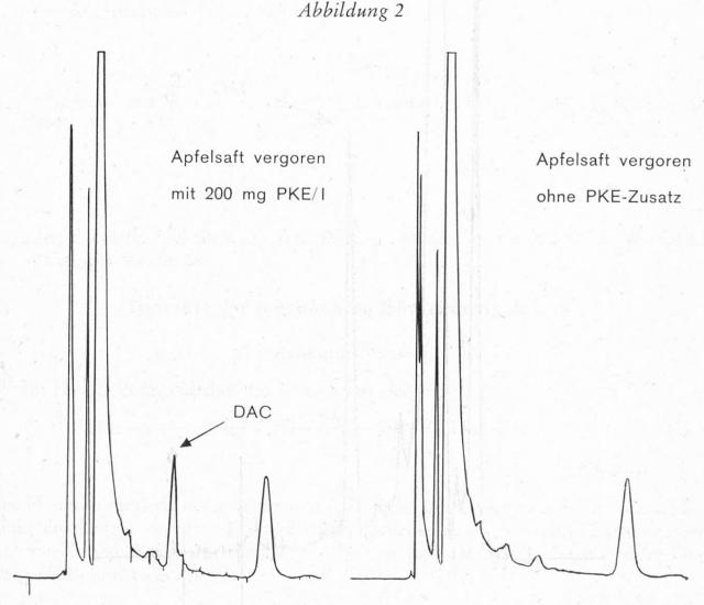
\* Füllung der Kolonne: Carbowax 4000 auf Chromosorb; Kolonnentemperatur 80 ° C; Trägergas Stickstoff; Injektionsmenge 2 µl.
