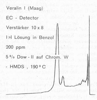
Abbildung 1. Gaschromatographische Trennung einer benzolischen Lösung von Veralin I (Maag) an Kolonne von 5 % Dow-11 auf Chromosorb W bei 190 % C, vorfolgt mit FID (oben) und ECD (unten). RT von Malathion = 4,6 Min.
