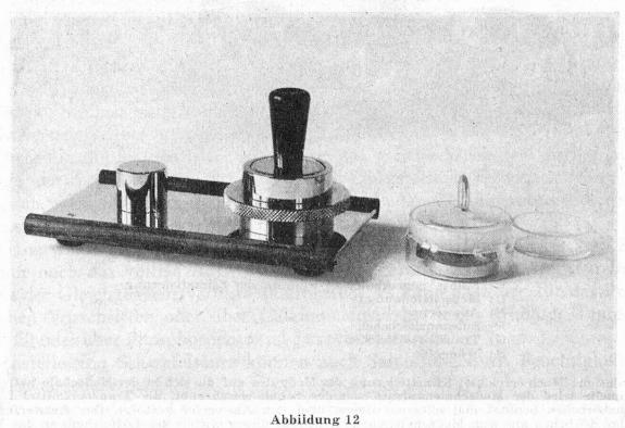
Anordnung der Sorptionsisothermeneinrichtung bei der Meßgutklimatisierung auf 100 % rF, GF.
