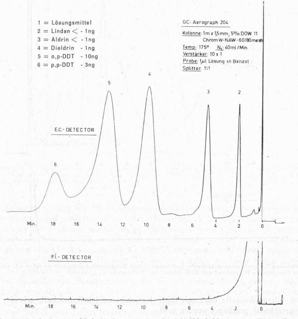
Abbildung 6. Gaschromatographische Auftrennung von Pestizid-Chlorkohlenwasserstoffen an Dow-11 auf Chromosorb W, verfolgt mit ECD (oben) und FID (unten). Peak 2 entspricht ca. 0,1 ng Lindan, Peak 3 ca. 0,3 ng Aldrin.
