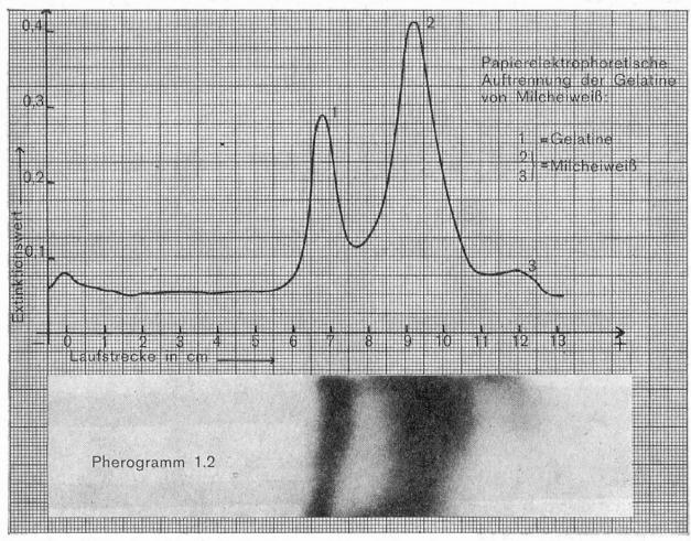
Extinktionsdiagramm des Pherogramms 1.2
