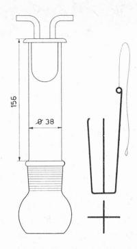
Figur 3 Apparatur für Heißextraktion nach Hadorn und Doevelaar.
