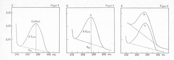
Figur 2 Absorptionskurve von 0,45 mg reinem Coffein in 100 ml Chloroform. Figur 3 und 4 Kurven a, b und c sind Absorptionskurven von 3 verschiedenen reinen Auszügen aus dem gleichen entcoffeinierten Röstkaffee.
