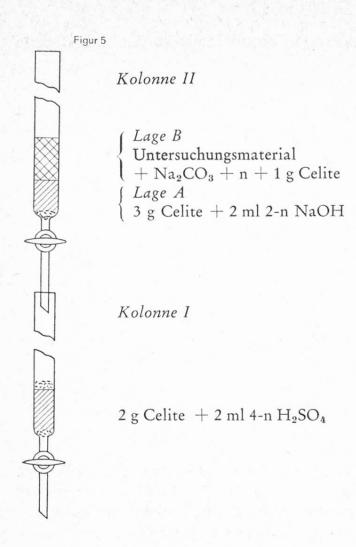
ein homogenes, leicht feuchtes Pulver erhalten wird. Dieses wird nun portionenweise in das unten mit Wattebausch oder Glaswolle verschlossene Rohr I eingefüllt. Mit einem flach gedrückten Glasstab wird die Celite-Masse leicht festgestampft, so daß eine gleichmäßige, homogene Schicht entsteht. Oben wir die Schicht mit einem Pfropfen aus Glaswolle zugedeckt, um Erosion zu verhindern.
