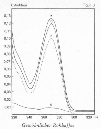
UV-Absorptionsspektren des Chloroform-Auszuges eines Schwefelsäure-Aufschlusses in Wasser
