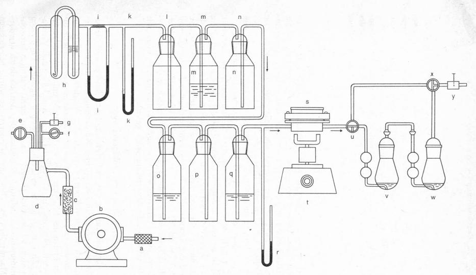
Figur 1 Apparatur zur Bestimmung der Aromadurchlässigkeit
