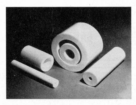
Wo bei TEFLON höchste Qualitätsgüte erforderlich ist, wie z. B. bei Lagern oder Dichtelementen an Kolben und Ventilen, soll in jedem Fall VERPRESSTES und, anschliessend an das Sintern, NACHVERDICHTETES Material eingesetzt werden. Nur nach dieser Fabrikationsmethode hergestellte Teile weisen beste mechanische Werte und Vakuumdichtheit auf.
