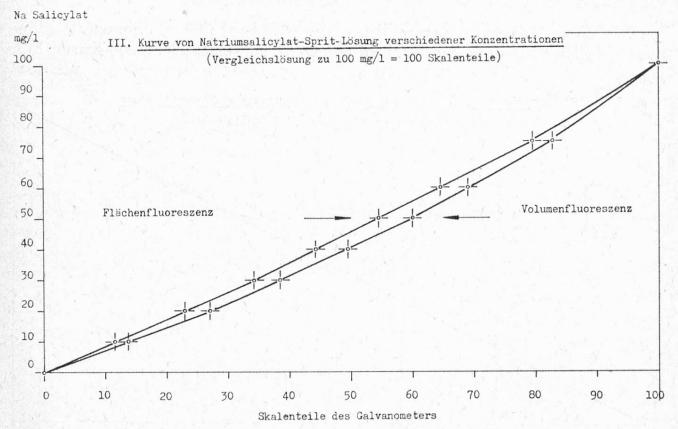
Bedeutend genauer sind die Resultate im 20 mg/l-Meßbereich. Diese Lösung wird wiederum durch Verdünnung der Stammlösung hergestellt. Als Vergleichstyp zur Einstellung des Eichwertes, 100 Skalenteile, wird eine Spritlösung
