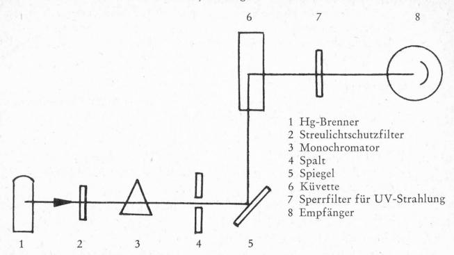
licht wird noch ein Sperrfilter (7) zwischen Küvette und Empfänger eingesetzt.
