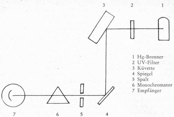
Messung wird die Aufstellung der Apparatur verändert. Die Aufnahme des Fluoreszenzspektrums (Farbtonbestimmung) erfolgt in der Aufstellung A und die Messung der Fluoreszenzintensität mit der Aufstellung B.
