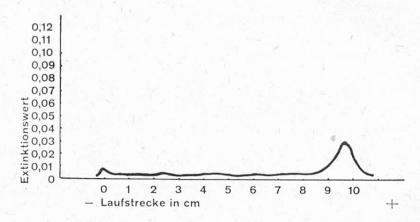
Abbildung 9 Extinktionsdiagramm des alkohollöslichen Prolamins in Rohreis
