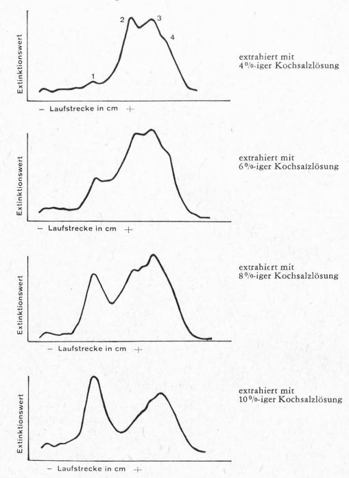
Abbildung 12 Extinktionsdiagramme des aus Rohreismehl mit 4-, 6-, 8- und 10prozentiger NaCl-Lösung extrahierten Eiweißes
