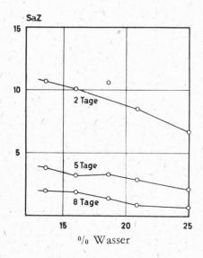
Figur 13 Einfluß des Wassergehaltes: Abnahme der SaZ während der Lagerung bei 50° C
