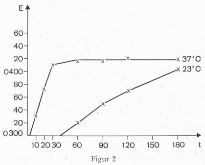
Abhängigkeit der Farbentwicklung von Temperatur und Zeit. – Alle Messungen mit Lösungen, die 4 γ P/8 ml enthielten. Die Zeit ist in Minuten angegeben.
