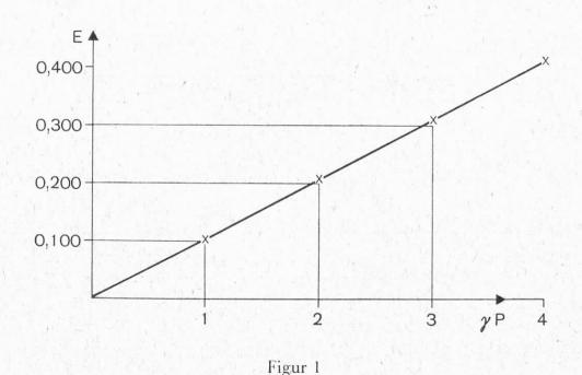
Eichkurve mit Phosphorstandardlösungen, Metrohm Spektralphotometer E 1007, Küvetten mit 1 cm Schichtdicke, Messung bei 820 mµ.
