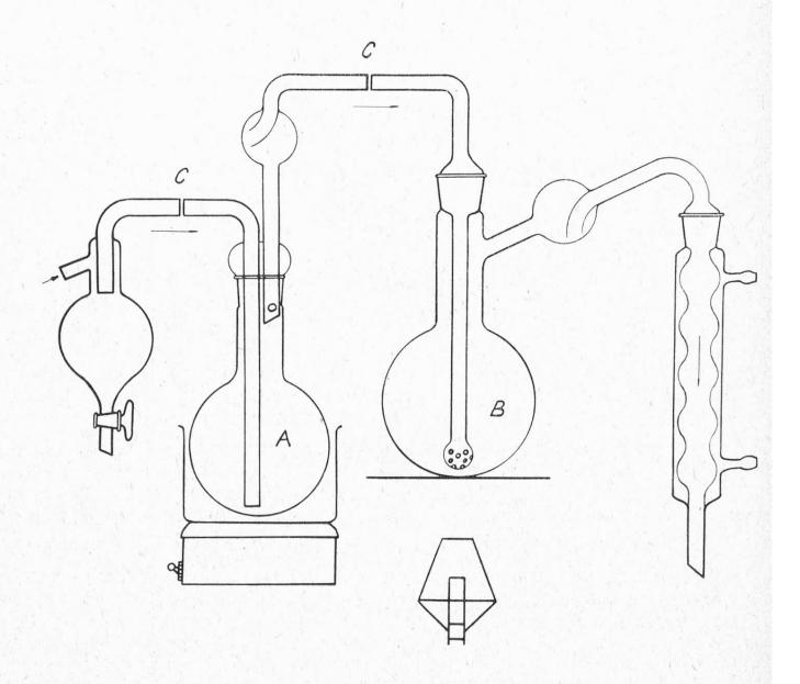
Le ballon A plonge dans un bain d'huile maintenu à 115-120° par un dispositif de chauffage électrique.
