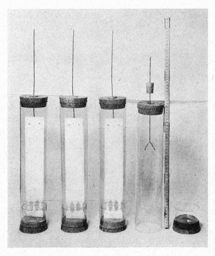
Abbildung 2 Chromatographiervorrichtung mit eingehängten Keilstreifen Rechts: Geöffnetes Gefäß ohne Inhalt, daneben ein Maßstab
