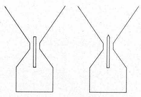
Abbildung 3 Form der Doppelkeilstreifen
