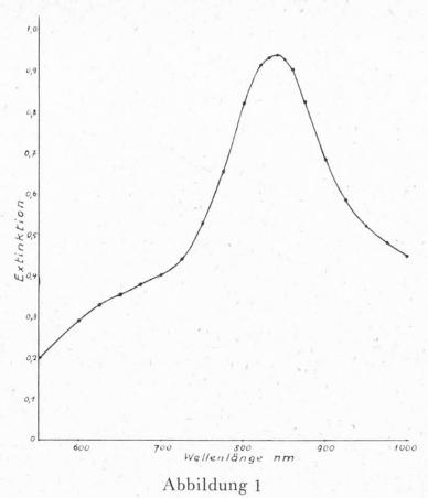
Absorptionskurve des As-Mo-Komplexes (Reagens Hahn Luckhaus) 80 µg As / 50 ml, 20 mm-Küvette
