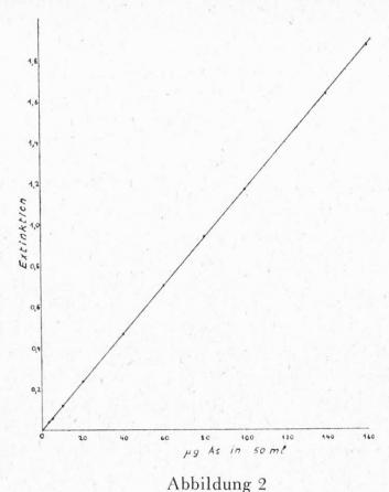
Eichkurve zu As-Bestimmung mit Reagens *Hahn-Luckhaus* Wellenlänge 840 nm, 20 mm- bzw. 10 mm-Küvette
