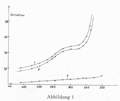
UV-Spektrum der wässerigen Analysenlösungen von Bienenhonig. Kurve 1: 2prozentige geklärte, wässerige Honiglösung. Kurve 2: Dieselbe Lösung nach 6stündiger Extraktion mit Aether. Kurve 3: Aetherextrakt nach Verdampfen des Aethers und Lösen des Rückstandes in Wasser.
