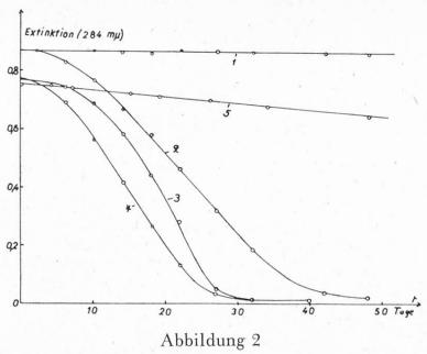
Verhalten des HMF in verdünnten, wässerigen Lösungen (Extinktion bei 284 mu in Funktion der Zeit). Kurve 1: Neutrale Lösung unter N2; Kurve 2: Reines Wasser in Kontakt mit der Luft; Kurve 3: Mit Citratpuffer, pH 5, unter N2; Kurve 4: Mit Citratpuffer, pH5, in Kontakt mit der Luft; Kurve 5: HCl, pH 2,6, unter N2.
