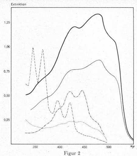
Absorptionsspektren der gefärbten Eluatfraktionen aus dem Säulenchromatogramm 2a
