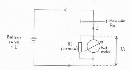
Es wird der Spannungsabfall (U<sub>i</sub>) im Röhrenvoltmeter abgelesen und der Widerstand (R<sub>x</sub>) des Oeles in der Messzelle mit folgender Formel berechnet:
