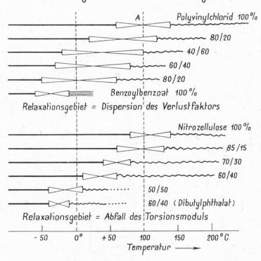
Der Erweichungsbereich von Polyvinylchlorid kann durch steigende Mengen des Weichmachers nach immer tieferen Temperaturen verschoben werden. Man ist somit imstande, durch solche Kombinationen von Weichmachern mit starren Kunststoffen kautschukelastische Produkte herzustellen.
