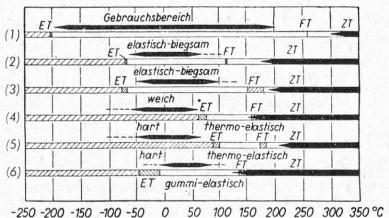
Zahlen links: (1) Polytrifluorchloraethylen (2) Polyaethylen (3) Polyisobutylen (4) Polyvinylchlorid (5) Polymethakrylat (6) Weichgemachtes Polyvinylchlorid
