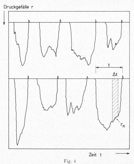
Beispiele von Zugprofilen des natürlichen Rauchens, mit Prinzipschema der graphischen Integrierung des Rauchzugprofils
