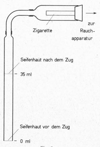
Fig. 2 Seifenhaut-Spirometer zur Messung des Luftzugvolumens vor der nicht entzündeten Zigarette
