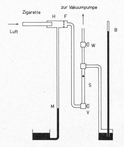
Fig. 1 Schema eines Apparates zur Messung des Zugwiderstandes von Zigaretten und Filterstäben
