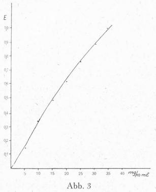
Eichkurve der Seliwanoff-Reaktion von Fructose. Filter S 57, Küvette 3 cm
