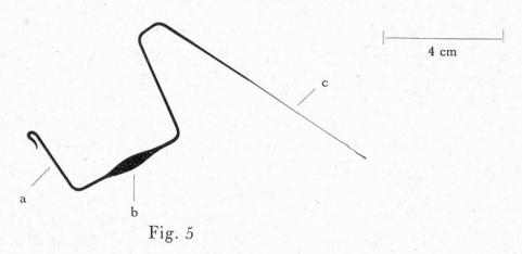
Die Pipette wird am zugeschmolzenen Bogen a) gefasst und mit dem Teil b) in eine Schale mit Eiswasser getaucht; gleichzeitig bringt man die Kapillare c) sorgfältig in das aufzusaugende Flüssigkeitsvolumen. Durch die Volumenver-
