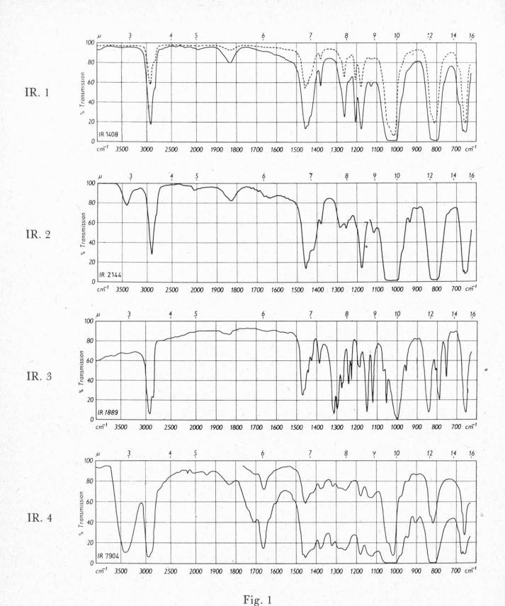
IR.-Absorptionsspektren von Thiometon und seinen Oxydationsprodukten
