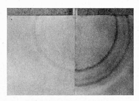
Abb. 5 Fettsäuren von unhydriertem Schweinefett mit zugesetzter Linolensäure
