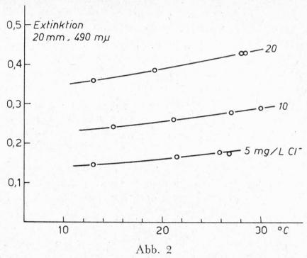
Temperaturabhängigkeit der Farbintensität, gemessen bei verschiedenen Chloridgehalten
