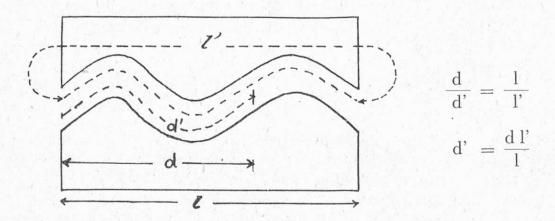
In Analogie zum Beweglichkeitsausdruck der freien Elektrophorese kann d' aber auch folgendermassen ausgedrückt werden:
