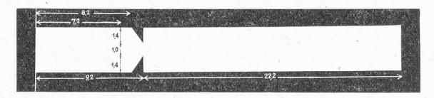
Abbildung 1 Streifenform zur Papierelektrophorese von Eiklar
