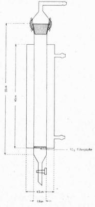
Abbildung 4 Chromatographie-Rohr
