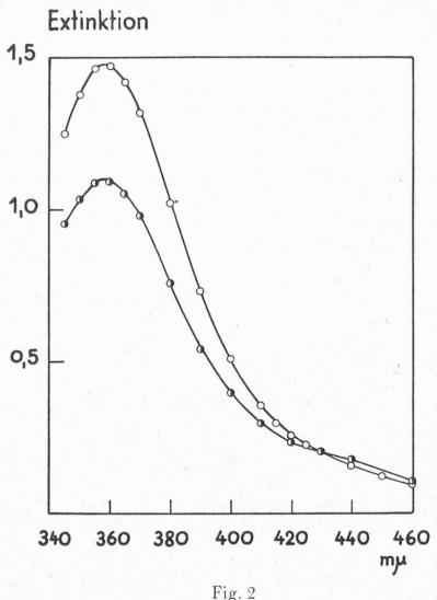
Obere Kurve = Absorptionsspektrum von 3,82 mg Jod in 100 ml absolutem Alkohol
