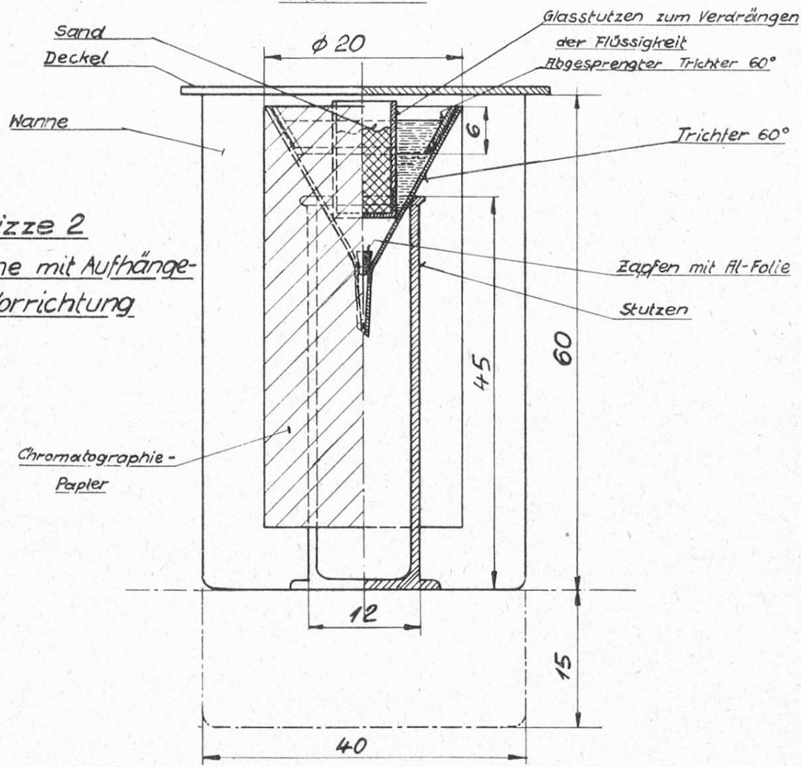
zu halten, wird ein beschwerter Glasstutzen (z.B. mit Sand gefüllter Stutzen) in das Innere des Trichters gestellt, wodurch Lösungsmittel verdrängt wird (siehe Skizze 2).
