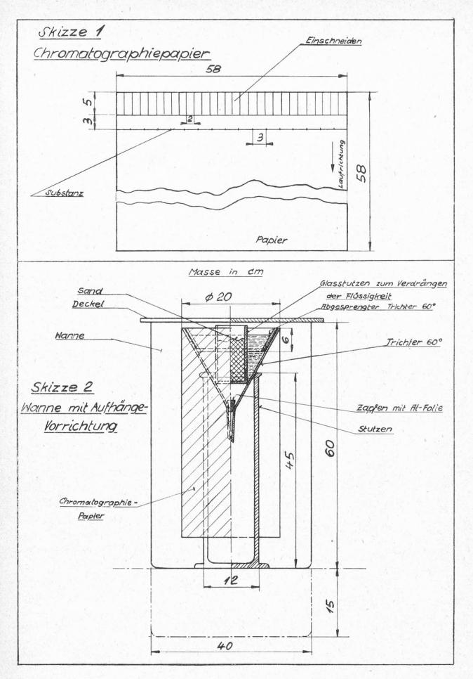
zu halten, wird ein beschwerter Glasstutzen (z.B. mit Sand gefüllter Stutzen) in das Innere des Trichters gestellt, wodurch Lösungsmittel verdrängt wird (siehe Skizze 2).
