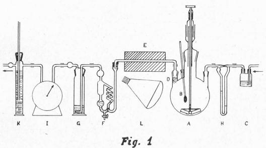
La figure 1 nous dispense de décrire en détail notre appareil. Le ballon A à 4 cols, en pyrex, a une capacité d'un litre. Le col central, très large, permet l'introduction aisée de la denrée; il est fermé par un bouchon de verre rodé à travers lequel passe un agitateur métallique à branches articulées. Un joint à mercure assure l'étanchéité du système. Un moteur électrique fait tourner cet agitateur à raison de 10 à 20 tours par minute par l'intermédiaire d'un réducteur de vitesse.
