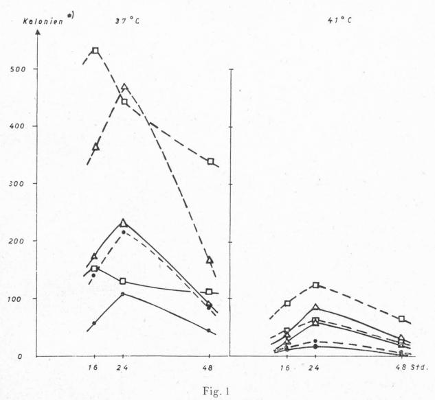
Bestimmung der Optimaltemperatur für das Wachstum und der optimalen Bebrütungsdauer von Colibakterien und anderen unter denselben Versuchsbedingungen gewachsenen Bakterienkolonien auf Membranfiltern bei Verwendung von drei verschiedenen Endoagars (Rheinwasser, unfiltriert)
