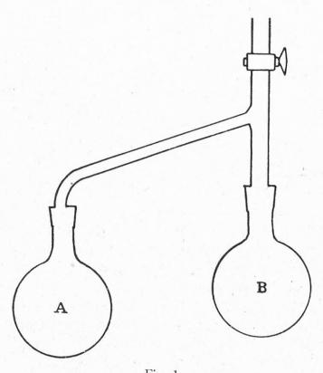
Fig. 1 Apparatur zum colorimetrischen Nachweis der Filtrationsenzyme in Säften
