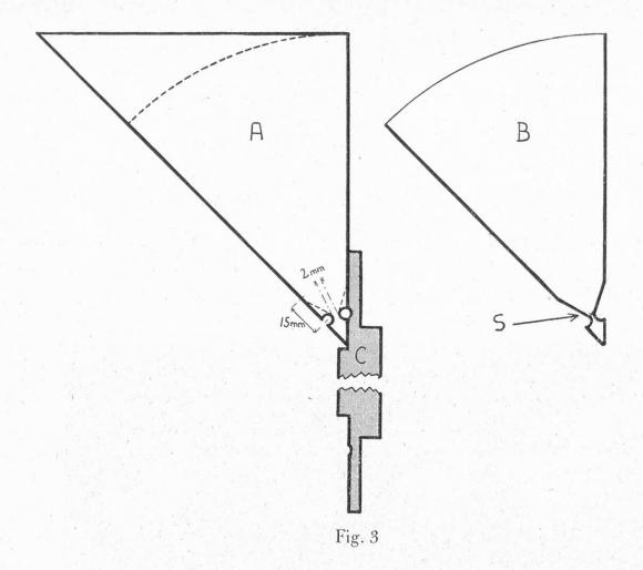
L'alimentation se fait par une mêche composée d'un rectangle de papier-filtre roulé serré que l'on introduit dans le trou central, dont la diamètre doit avoir au plus 2 à 3 mm. La mêche, en général longue de 25 mm, ne doit dépasser le disque que de 2 à 4 mm. Pour un alimentation abondante on peut utiliser aussi des mêches faites de ouate.
