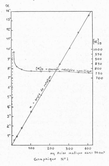
Le pouvoir rotatoire varie d'autre part en fonction du pH et de la concentration en molybdate d'ammonium. Il est donc nécessaire de travailler dans des conditions déterminées d'acidité et de concentration en molybdate.
