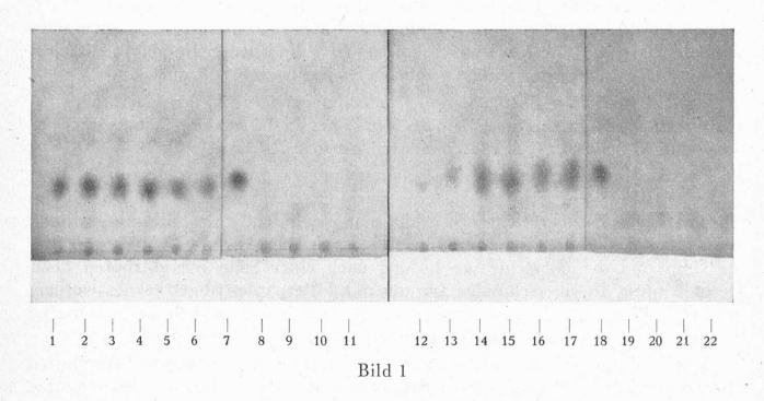
72stündiges Durchlaufchromatogramm mit sek. Butanol und 3 % NH3 im Verhältnis 1:3 Punkte 1—5 Rindextrakte, P 6 Schafextrakt, P 7, 18 Testflecken von je 3 γ Carnosin und Histidin, P 8—11 Hefeextrakte, P 12—15 Hühnerextrakte, P 16—17 Walextrakte, P 19—22 Würzen.
