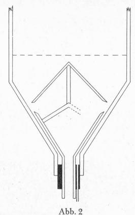
Einrichtung zur Trennung von Kot und Harn
