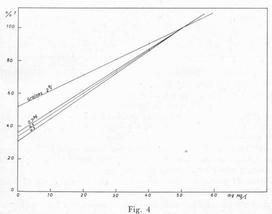
Courbes de dosages de Mg (383) dans les feuilles, à 0,3 %, 0,5 % et 0,7 % de matière sèche et de Mg (383) dans les graines à 2,0 % de matière sèche
