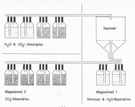
Abb. 1 Prinzip des Rattenrespirationsapparates
